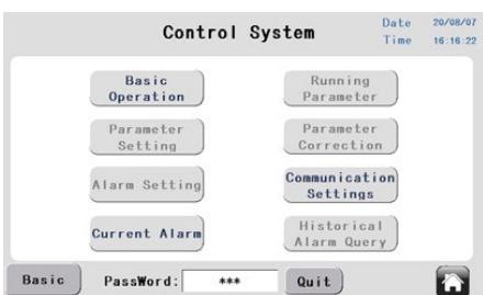
Предусмотрен стандартный интерфейс RS485 и протокол MODBUS RTU. Система управления чиллера подключается к системе автоматизации здания (BAS), которая осуществляет централизованное управление и удаленный мониторинг, а также управление другими подключенными устройствами..
