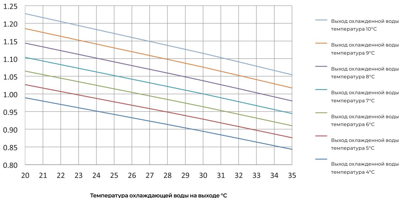
График поправочного коэффициента для потребляемой мощности
